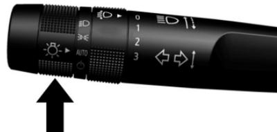
El control de las lámparas exteriores está en la palanca de señal direccional.
