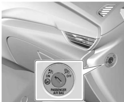
El sistema de bolsa de aire del pasajero delantero se puede desactivar por medio de un seguro en el lado del tablero de instrumentos, visible cuando la puerta del pasajero delantero está abierta.
