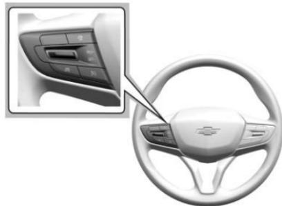
: Oprima para encender y apagar el sistema de control de velocidad constante. Se enciende un indicador blanco en el grupo de instrumentos cuando se enciende el control crucero.
