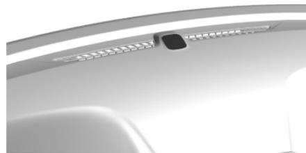
Hay un sensor de luz en la parte superior del tablero de instrumentos. No cubra el sensor.
