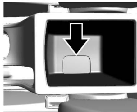
Abra la cubierta en la parte inferior del portavasos en la consola central. Despliegue la punta de la llave de la llave electrónica e insértela como se muestra en la figura.
