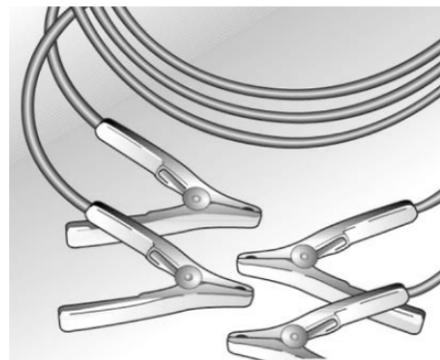
Un vehículo con la batería descargada puede arrancarse con extensiones pasacorrentes y la batería de otro vehículo. Esto se debe realizar con extremo cuidado y siguiendo las instrucciones a continuación.
