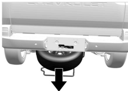
7. Levante la jaula de la llanta de refacción ligeramente y desconecte ambos extremos del gancho.
