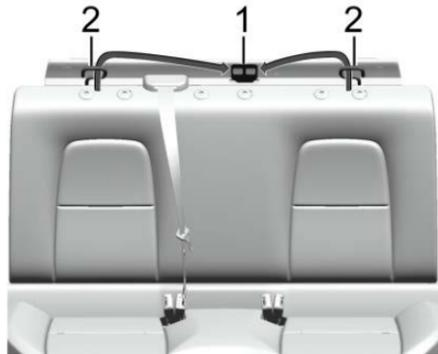
La atadura superior se enruta a través de los aros (2) al anclaje de atadura superior (1). Asegúrese de leer las instrucciones siguientes para instalar adecuadamente un asiento de seguridad para niños utilizando estos aros y el anclaje.
