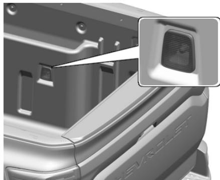
Si está equipado, la luz de carga exterior está ubicada en el tablero lateral interno y tiene la función de iluminar el área de carga.
