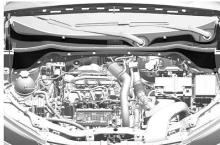
La admisión de aire en la parte delantera del parabrisas en el compartimento del motor se debe mantener limpia para permitir la entrada de aire. Retire las hojas, suciedad o nieve.
