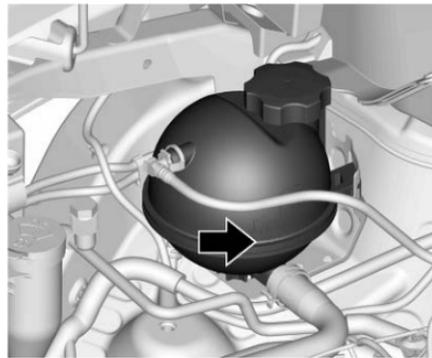
El tanque de compensación del refrigerante se encuentra en el compartimento del motor, en el lado del pasajero del vehículo. Vea *Vista general del compartimento del motor* ⇨ 149.
