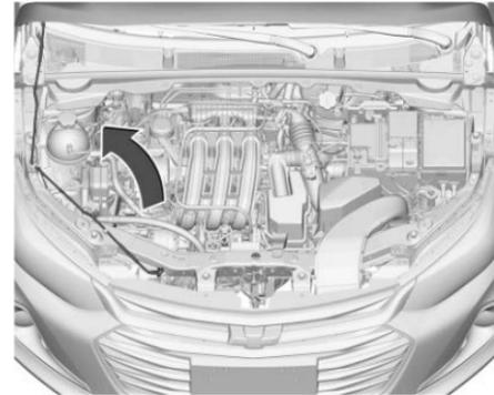
Para mantener el cofre del motor abierto, inserte la varilla de soporte en el orificio en el cofre del motor.
