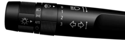
Mueva la palanca completamente hacia arriba o hacia abajo para señalar una vuelta.
