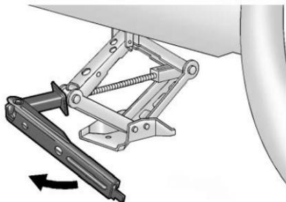
4. Levante el vehículo, haciendo girar la manija del gato en el sentido de las manecillas del reloj. Eleve el vehículo a una altura tal, de manera que haya espacio suficiente para que la llanta usada no toque el suelo.
