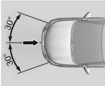
El sistema de bolsa de aire delantera se acciona en caso de un accidente de cierta gravedad en la zona descrita. La ignición debe estar encendida.
