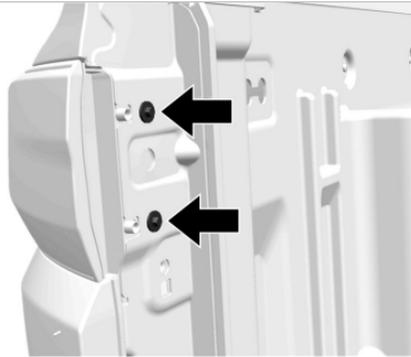
2. Retire ambos tornillos que sujetan el ensamble de la luz trasera a la carrocería del vehículo.
