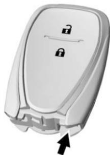
2. Separe las dos mitades del transmisor utilizando una herramienta plana insertada en el área cerca a la ranura de la llave.
