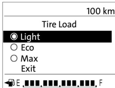
Para ajustar Carga de llantas en el menú del Centro de información del conductor (DIC), detenga el vehículo y aplique el freno de estacionamiento. En vehículos de transmisión automática, cambie a P (estacionamiento).
