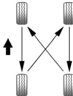
Diferentes fuerzas en las llantas delanteras y traseras las hace desgastarse de manera diferente, dependiendo de varios factores, como la superficie del camino, la manera de conducir, alineación de la suspensión, balanceo de las ruedas, presión de las llantas, etc.
