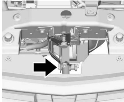
Empuje el gancho de seguridad hacia el lado del conductor y abra el cofre.
