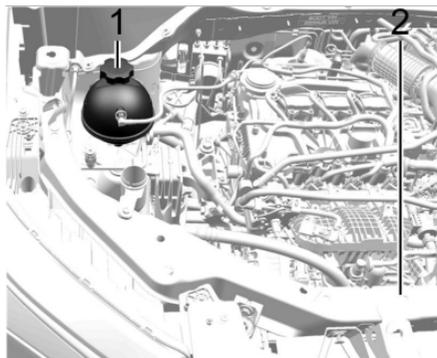
1. Tanque de compensación y tapón de presión del refrigerante
