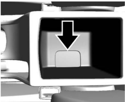
1. Coloque la llave no remota o el transmisor en la consola central o en el descansabrazos. Las posiciones correctas se muestran en las figuras.
