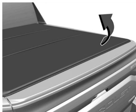
2. Jale las manijas para desbloquear la cubierta tonneau, de forma que pueda usar el compartimiento de carga.
