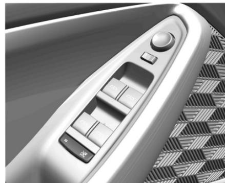
Presione el interruptor
