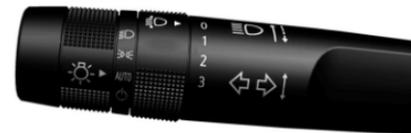
☰●: Con los faros encendidos, presione la palanca de señal direccional hacia adelante y libérela para encender las luces altas. Para volver a las luces bajas, empuje la palanca de nuevo o júlela hacia usted y libérela.
