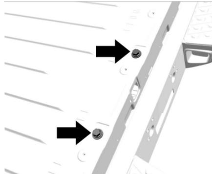
4. Gire cada perno hexagonal 10 veces en sentido contrario a las manecillas del reloj, y repita esta operación 3 veces. Esto bajará la jaula de la llanta de refacción y dará acceso a la llanta de refacción.
