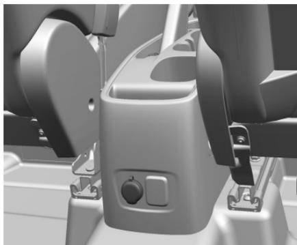
Los tomacorrientes para accesorios se pueden usar para conectar equipos eléctricos, como un teléfono celular, cargadores de GPS o cualquier otro dispositivo de 12V que no exceda los 120W.
