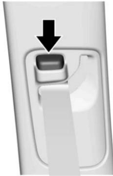
Oprima el botón de liberación y mueva el regulador de altura a la posición deseada. El regulador puede moverse hacia arriba empujando el deslizador/compensador hacia arriba. Después de que el ajustador se coloque en la posición deseada, intente moverlo hacia abajo sin presionar el botón de liberación, para confirmar que se haya asegurado en su posición.
