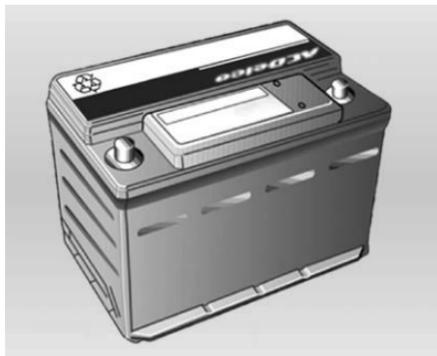
La batería ACDelco que se encuentra equipada en si vehículo no requiere mantenimiento periódico. Si el vehículo no es utilizado por 30 días o más, desconecte el cable negativo de la batería para no descargarla.
