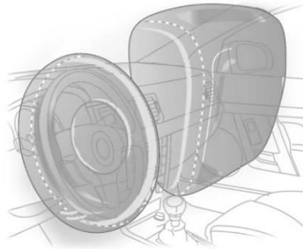
Las bolsas de aire delanteras son dispositivos de protección complementarios, que junto con los cinturones de seguridad delanteros, incrementan la protección de los pasajeros delanteros en una colisión frontal en un vehículo que desacelerar de forma muy abrupta. Su función es proteger la cabeza y el pecho contra impacto violento en el volante o el tablero de instrumentos en accidentes donde los cinturones de seguridad no serían suficientes para prevenir lesiones serias y/o la muerte.
