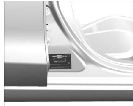
La Placa de identificación del vehículo se ubica en el pilar de la puerta delantera derecha.
