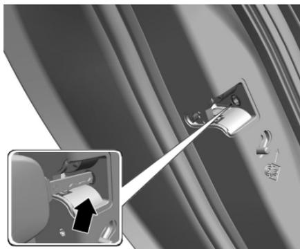
Después de esta acción, las puertas solo se pueden desbloquear mediante la manija interior y no mediante el pasador.
