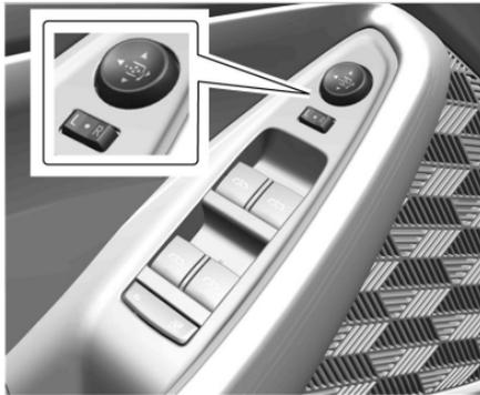
Si está equipado, el control para los espejos eléctricos se encuentra en la moldura de la puerta al lado del conductor.
