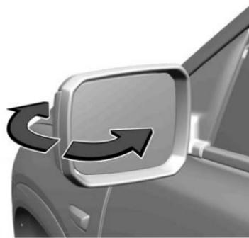
Para seguridad de los peatones, los espejos exteriores se giran fuera de su posición normal de montaje si se golpean con suficiente fuerza. Vuelva a colocar el espejo aplicando una ligera presión a la carcasa del espejo. Esta función también es útil para reducir el ancho total del vehículo para prevenir daños cuando el vehículo esté estacionado. Empuje el espejo hacia atrás en la posición de funcionamiento antes de conducir.
