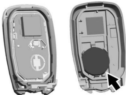
3. Retire la batería empujándola y deslizándola hacia la parte inferior del transmisor.
