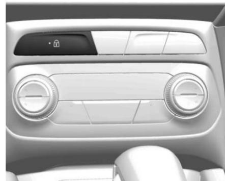
La luz indicadora, integrada en el interruptor de seguros eléctricos de la puerta, indica el estado del sistema.
