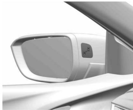
Cuando la velocidad del vehículo es mayor a 10 km/h, se activará el sistema de alerta de punto ciego lateral. Cuando la velocidad del vehículo es mayor a 140 km/h, el sistema se apagará, y la luz indicadora de los espejos exteriores izquierdo y derecho se atenuará; en este momento, si se reduce la velocidad del vehículo, se apagará la luz indicadora del espejo. Si un vehículo se detecta en el punto ciego en este momento, la luz indicadora del espejo retrovisor correspondiente se iluminará.
