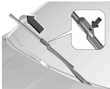
1. Tire del ensamble de la hoja del limpiaparabrisas para separarlo del parabrisas.
