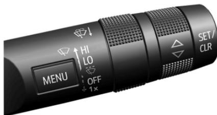
Con la ignición encendida o en ACC/ACCESSORY (accesorios), mueva la palanca del limpiaparabrisas para seleccionar la velocidad del limpiador.
