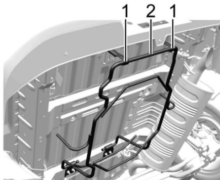
Revise visualmente la jaula y los ganchos para asegurar el almacenamiento adecuado. Cuando esté completamente almacenado, la manija del portador de llanta de refacción (2) debe estar ligeramente arriba del borde inferior de la fascia trasera. Ambos ganchos (1) deben estar conectados en el portador y apretados. Se debe observar movimiento lateral mínimo cuando se aplique fuerza normal a la manija.
