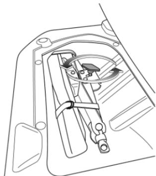
1. Gire el perno de sujeción de la herramienta del vehículo para sacar la herramienta.
