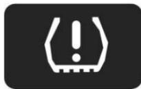
Cuando una llanta está poco inflada, inflada excesivamente, se poncha rápidamente o el sistema está fallando durante la conducción, la luz de advertencia del sistema de monitoreo de presión de llantas (amarilla) en el grupo de instrumentos se iluminará, acompañado de un aviso de voz.
