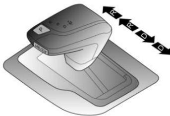
Presione y jale brevemente la palanca de cambios hacia la dirección requerida (dos posiciones para la parte delantera y trasera). Después de soltar la palanca de cambios, la palanca de cambios volverá a la posición central.
